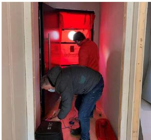
*Figura 14. Ensayo Blower Door (Fuente: Medgón PassivHaus)*
