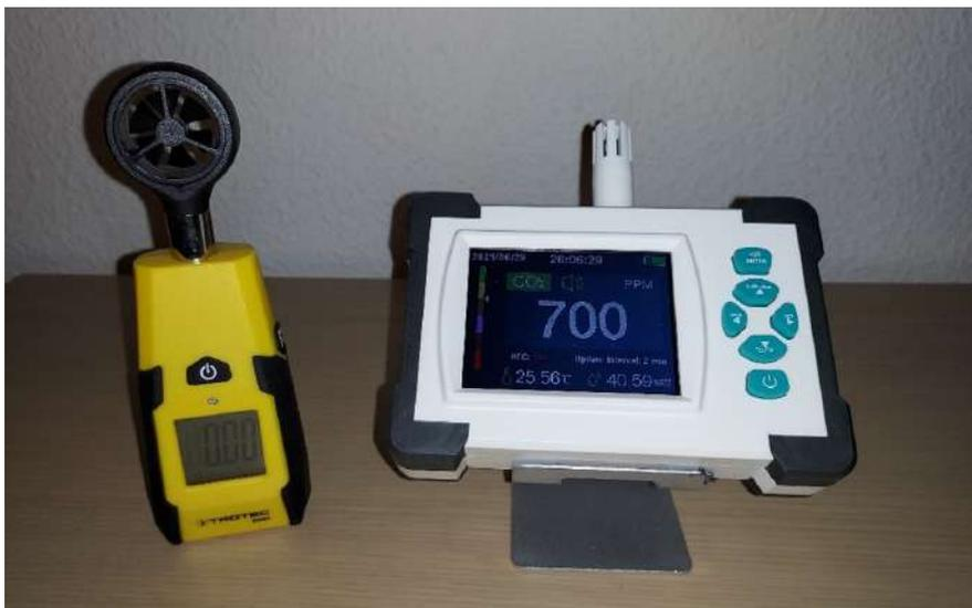
Figura 3 Modelo de medidor de CO<sub>2</sub> y anemómetro (Fuente: Luis Jiménez López)
