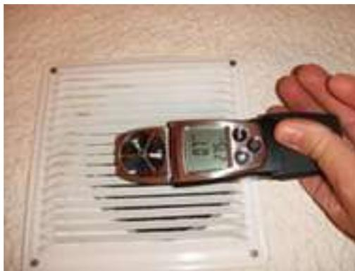
*Figura 5. Medición con anemómetro en rejillas de ventilación
